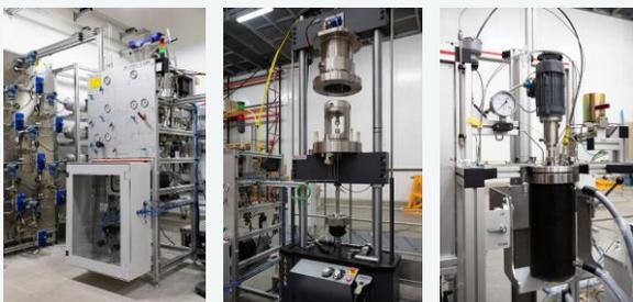
Essais statiques jusqu'à 100 barg et de 0 % à 100 % d'hydrogène
