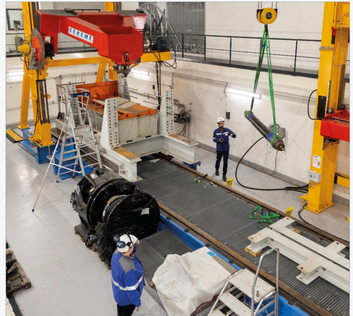
Réalisation de tests d'agression et d'éclatement pour mesurer la résistance des matériaux composites innovants.
