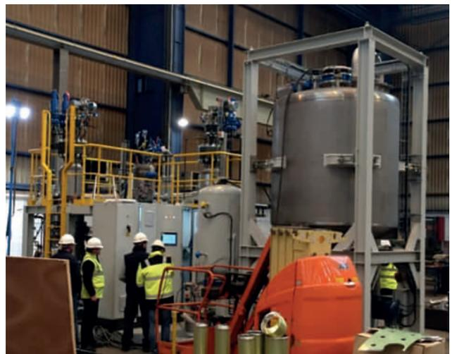
Figure 15 : Démonstrateur d'oxydation hydrothermale réalisée par Leroux & Lotz Technologies dans le cadre du projet Leanships H2020.
