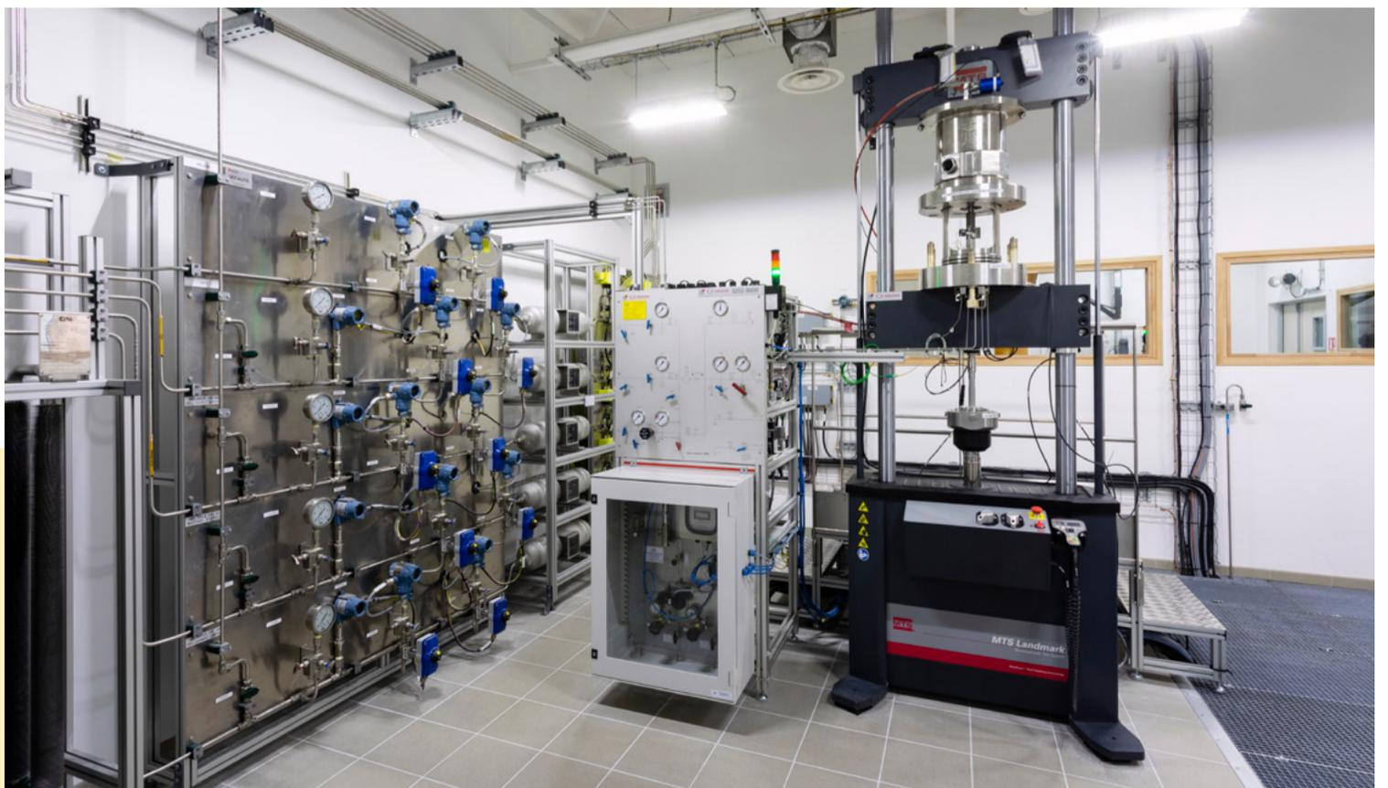
La machine de traction réalise des essais de résistance sous pression et en environnement jusqu'à 100 % d'hydrogène.
