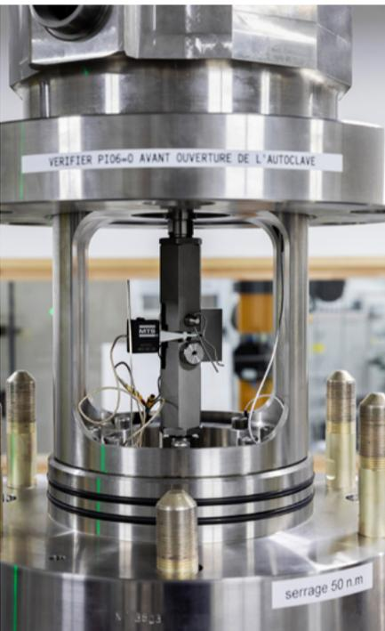
Une éprouvette dans la machine de traction.
